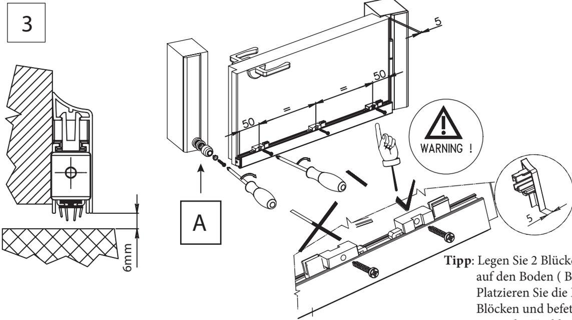
**Tipp:** Legen Sie 2 Blöcke von etwa 5mm auf den Boden ( Blöcke nicht mitgeliefert ). Platzieren Sie die Bodendichtung auf den Blöcken und befestigen Sie die Bodendichtung gegen das Türblatt.
